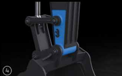
④ Punta de fundición reforzada
