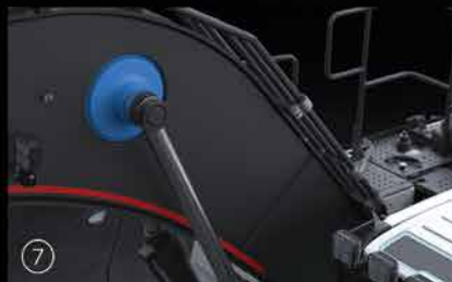
⑦ Cojinete del cilindro de la pluma de fundición reforzado
