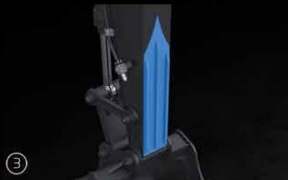
③ Componentes de sustentación del balancín reforzados
